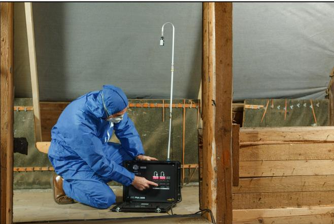
nach **VDI 3492** (z.B. Messungen zur Bestandsaufnahme, Kontrollmessungen vor Aufhebung von Schutzmaßnahmen, ...)
