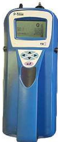
Abb. 8: P-Trak Ultrafine Particle Counter (UPC, Modell 8525, Fa. TSI), (eigenes Foto)
