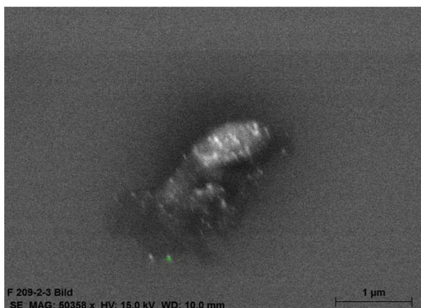
Abb. 28: REM-Aufnahme: voll ausgerüstetes Textil (Mai 2013), EDX-Detektor, 50.358x, Markiert ist der Punkt, an dem das in Abb. 29 dargestellte Spektrum aufgenommen wurde
