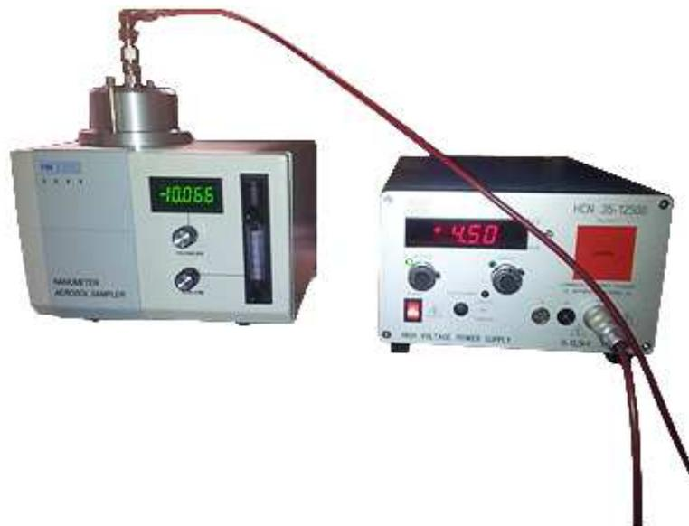
Abb.10: Nanometer Aerosol Sampler (NAS, Modell 3089, Fa. TSI), (eigenes Foto)
