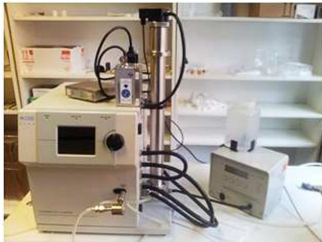
Abb. 9: Scanning Mobility Particle Sizer (SMPS, Modell 3936, Fa. TSI), (eigenes Foto)
